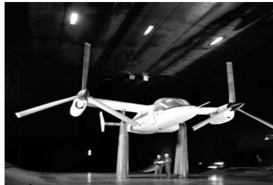
Slika 9. XV-15 u zračnom tunelu Ames centra
