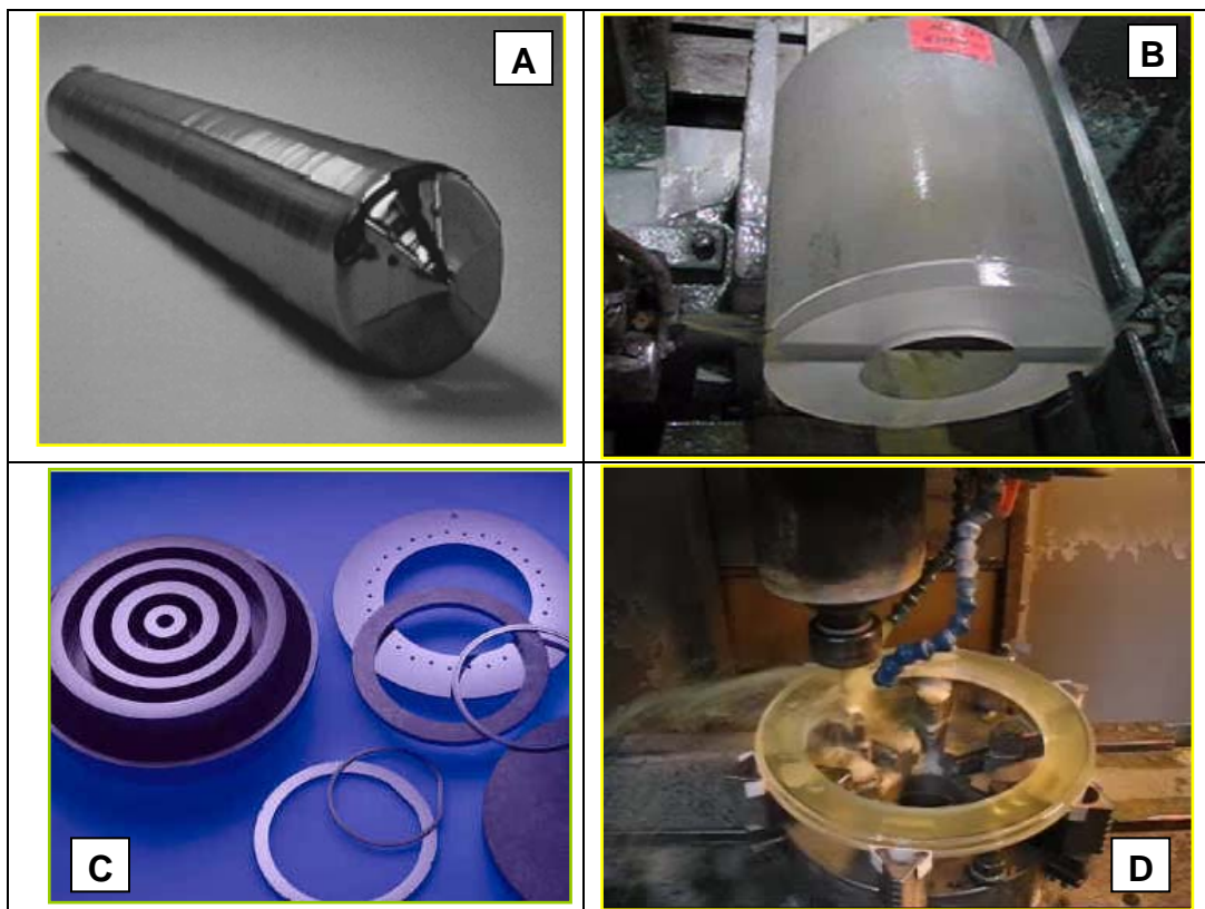
Slika 1. (A) Ingot monokristala Si, (B) taljeni \text{SiO}_2 , (C) proizvodi od monokristala Si i (D) proizvod od taljenog \text{SiO}_2 .
