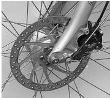
Slika 18. Prednja disketna kočnica montirana na prednju vilicu
