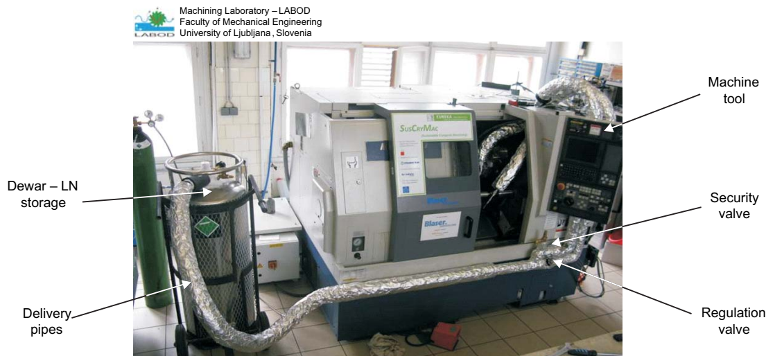
Figure 4 Cryogenic machining set-up Slika 4. Postavke opreme za kriogenu obradu rezanjem
