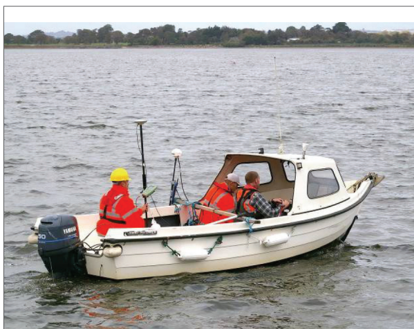
Slika 5.2. Terenska snimanja profila brzina uporabom ADCP-a s čamca
