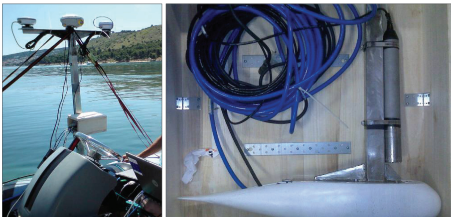
Slika 3.1. Višesnopni dubinomjer ODOM ES3M
