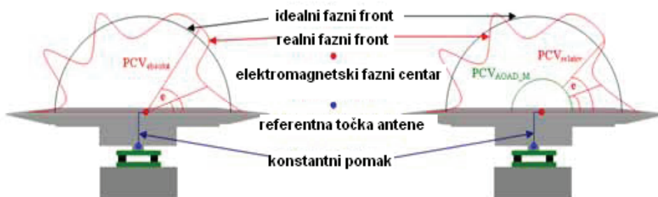
Sl.3. Utjecaj elektronskog faznog centra na određivanje elipsoidne visine
