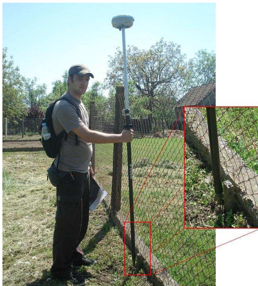
Slika 41. Izmjera kontrolnih točaka CROPOS-om
