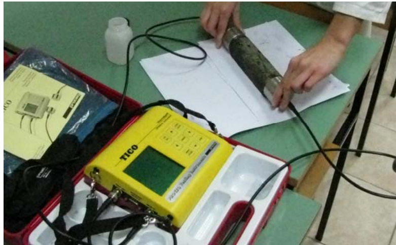
Slika 3. Mjerenje ultrazvučnim uređajem TICO Proceq Testing Instruments (El. uređaj: mjerno područje ~15-6550 \mu\text{s} , rezolucija 0,1 \mu\text{s} , naponski puls 1 kV, Brzina ponavljanja pulsa 3 \text{s}^{-1} , Ulazna impedancija 1 \text{M}\Omega ; Ultrazvučne sonde: f=54 \text{ kHz} ).
