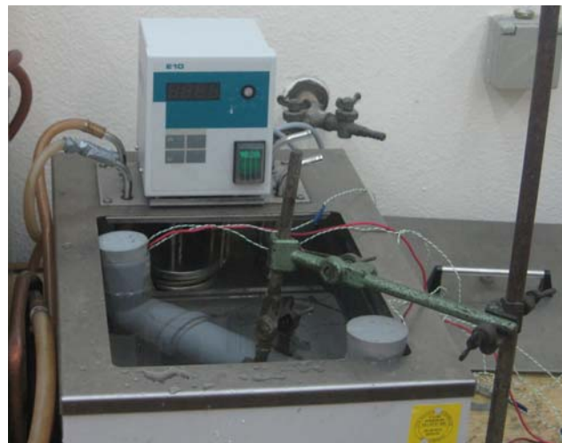
Slika 6. Eksperimentalni postav pri mjerenju toplinske vodljivosti materijala metodom vruće žice.
