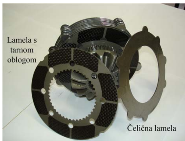
Slika 7-2. Fotografija lamela spojke.
