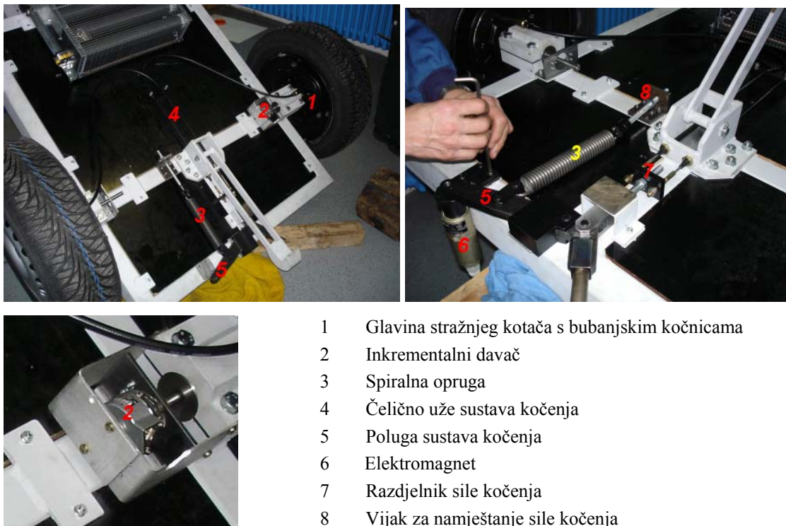
Slika 3-3. Fotografije sklopa stražnjeg kotača.
