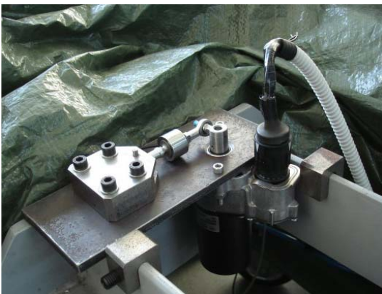
Slika 8-3. Fotografija postava za identifikaciju istosmjernog motora aktuatora.
