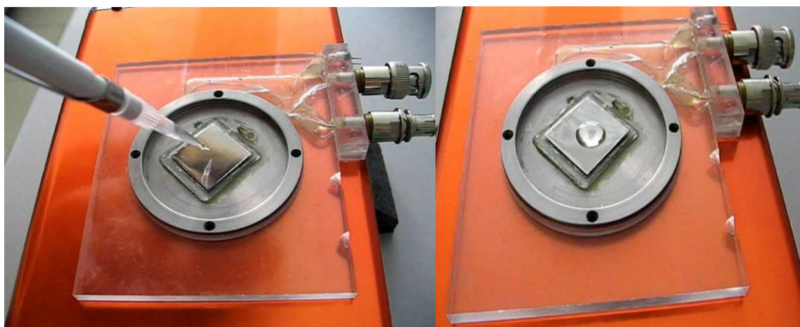
Slika 4: Stavljanje uzorka u komoru
