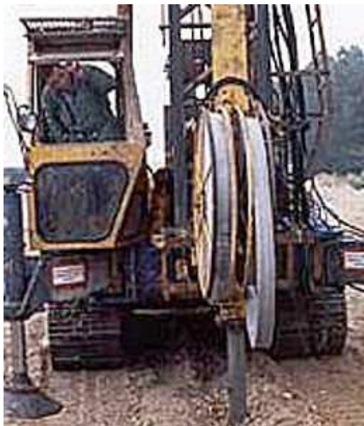
Slika 9.58 Uređaj za ugradnju savitljivih (mekih) drenova
