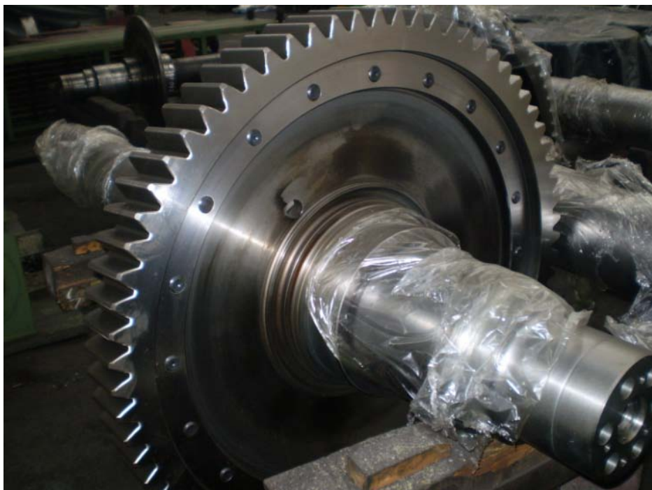
Slika 2.22 Montiran vijenac zupčanika
