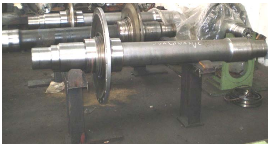
Slika 2.13 Glavina navučena na vratilo kolnog sloga
