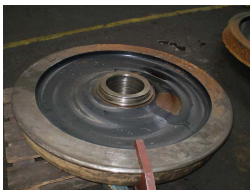
Slika 2.3 Monoblok kotač s labirintom
