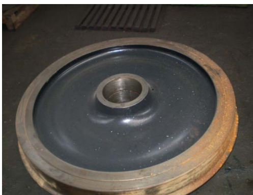
Slika 2.1 Monoblok kotač bez labirinta
