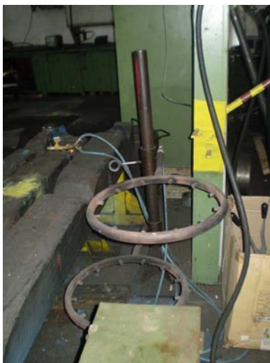
Slika 2.12 Postolje za zagrijavanje glavine vijenca zupčanika
