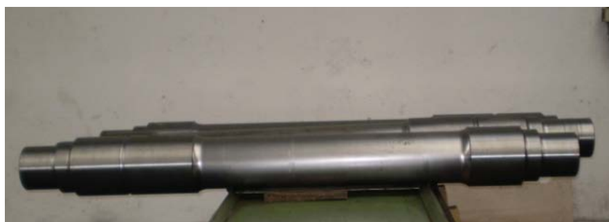
Slika 2.11 Vratilo kolnog sloga
