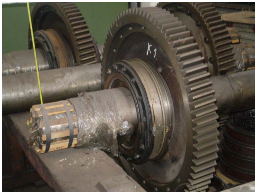
Slika 2.26 Montirani poklopci ležaja
