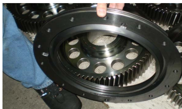
Slika 2.25 Držać dvorednog ležaja
