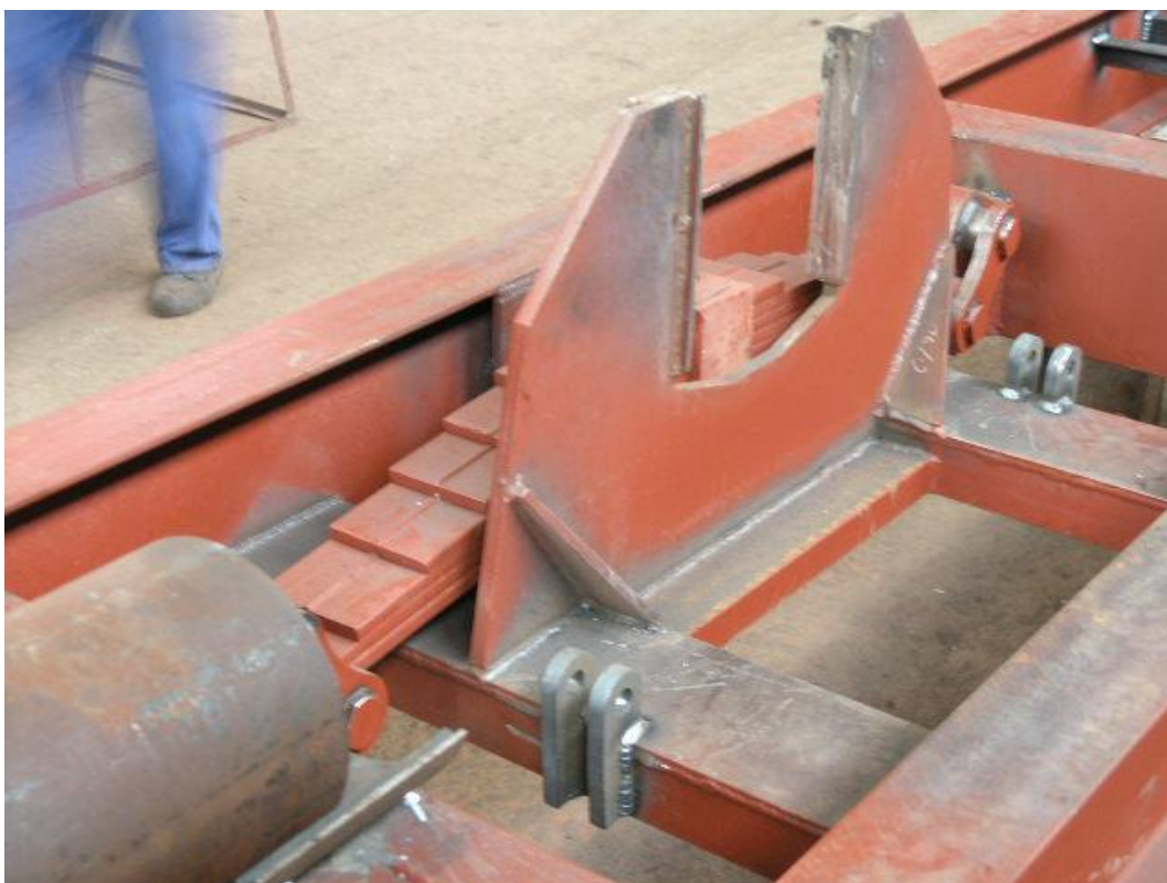
Slika 3.1 Vodilica osovinskog sklopa i ogibljenje
