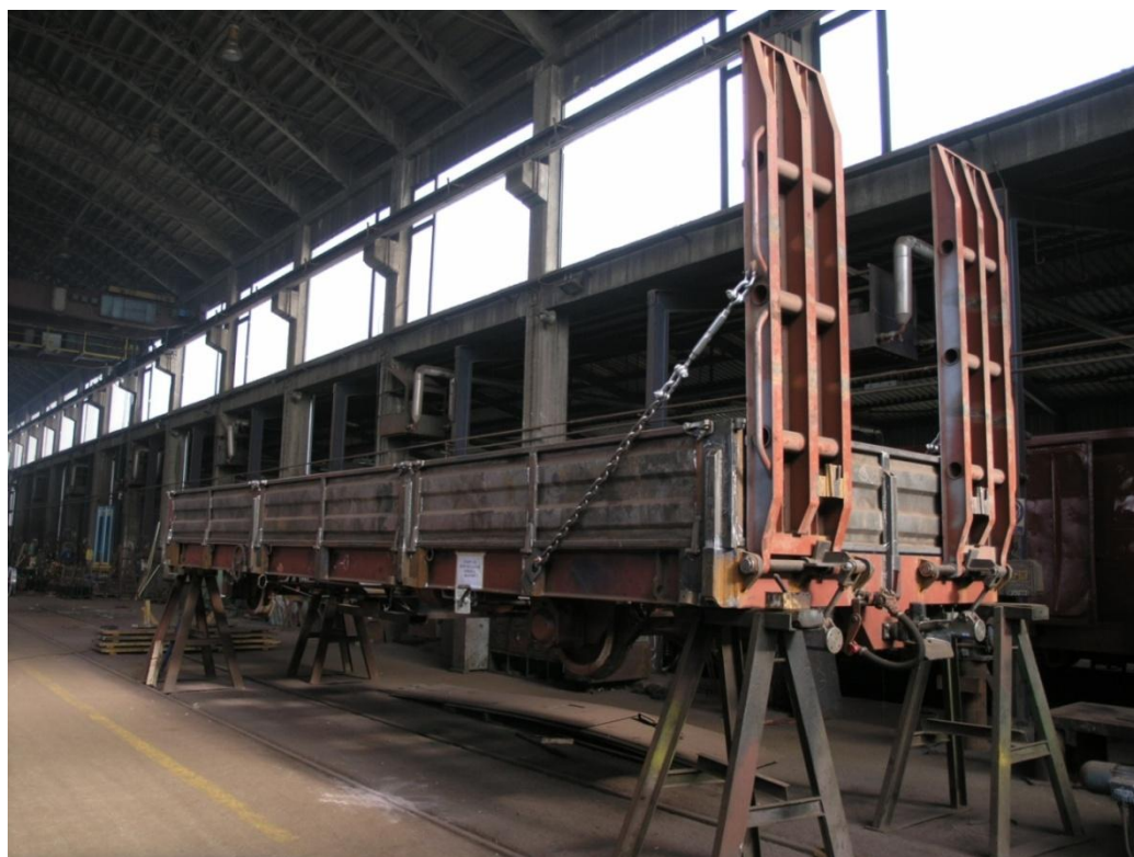
Slika 3.8 Ugradnja stranica i rampe za utovar
