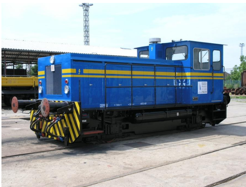
Slika 1.4 Rekonstruirana lokomotiva DHL300 za manevriranje
