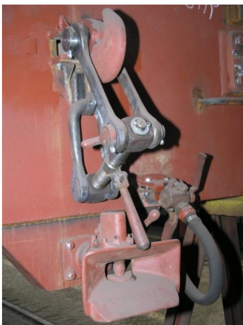
Slika 3.3 Vlačna sprema i automatsko kvačilo Rockinger
