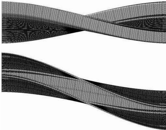
Figure 19 Deformation of uniform pontoon, lateral and bird's-eye view Slika 19 Deformacije jednolikog pontona, bočni i ptičji pogled
