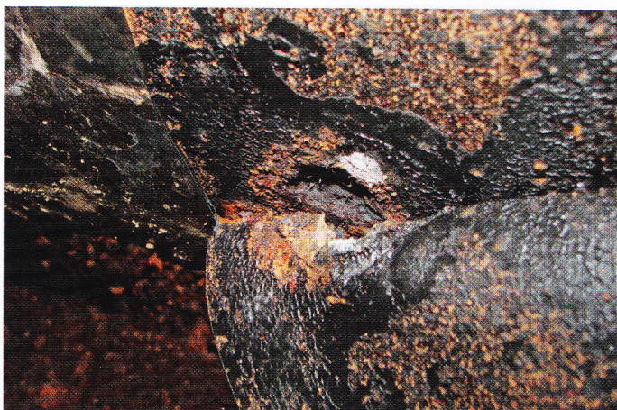
■ Slika 2. Oštećenje izazvano lutajućom strujom nakon skidanja izolacije i nakon pjeskarenja.
