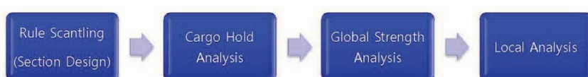
Figure 8 Overview of structural design of ULCS Slika 8 Pregled osnivanja konstrukcije ultravelikih kontejnerskih brodova
