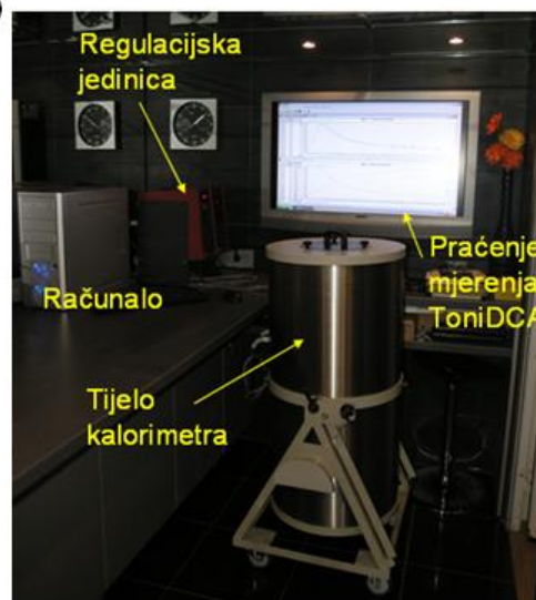
Slika 1 – a) tijelo kalorimetra ToniCal; b) mjerni sustav ToniCAL 7336
