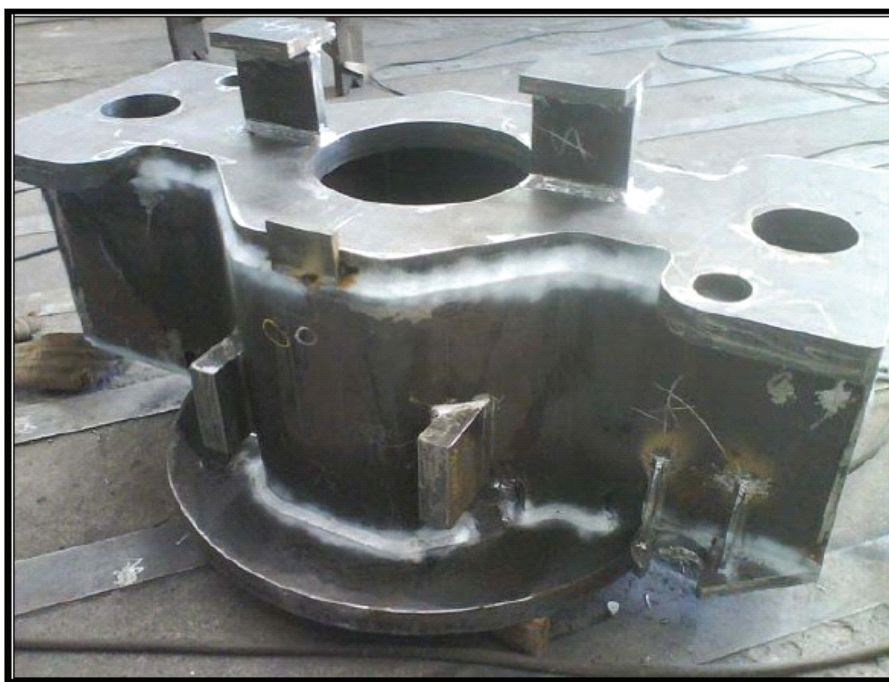
Slika 4.1 Složeni radni komad pripremljen za popuštanje
