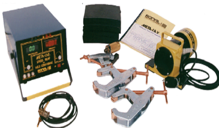
Slika 3.1 Oprema za smanjenje naprezanja metodom vibriranja [4]
