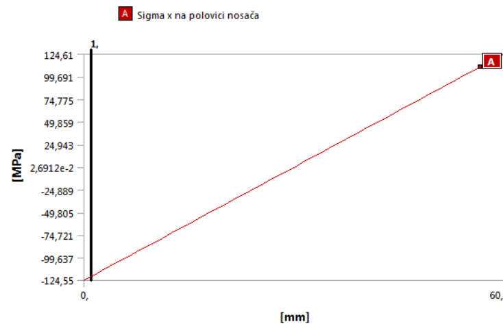
Slika 4.7 Raspodjela naprezanja po visini nosača h na polovici konzolnog nosača
