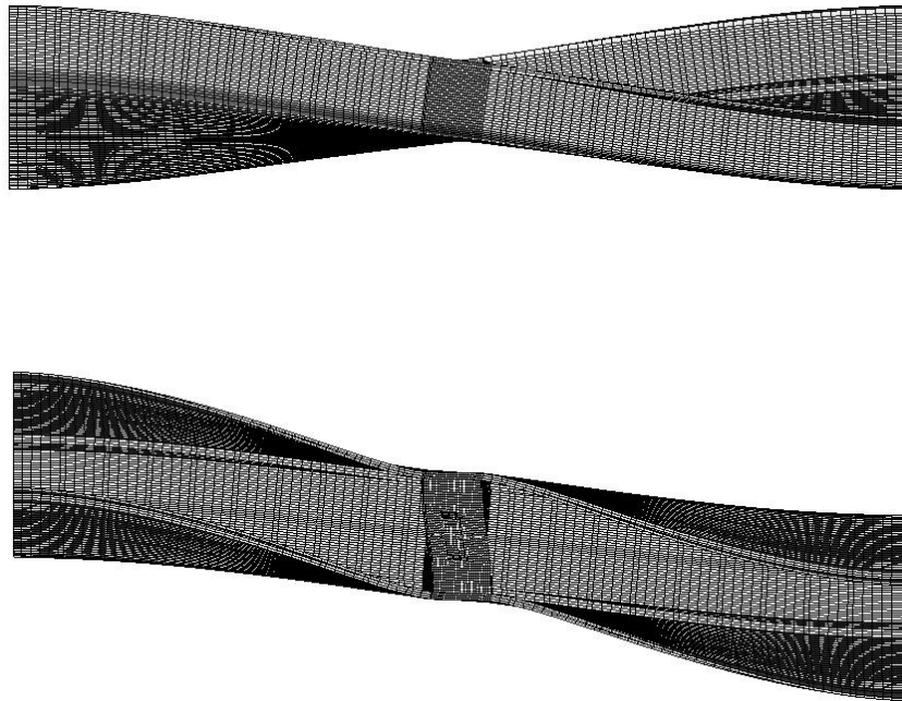
Slika 5.21 Deformacija segmentnog pontona bez pregrada, bočni i ptičji pogled
