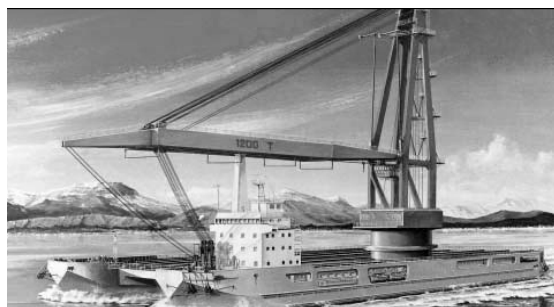
Slika 8. Katamaranska dizalica podizne moći 12000 kN
