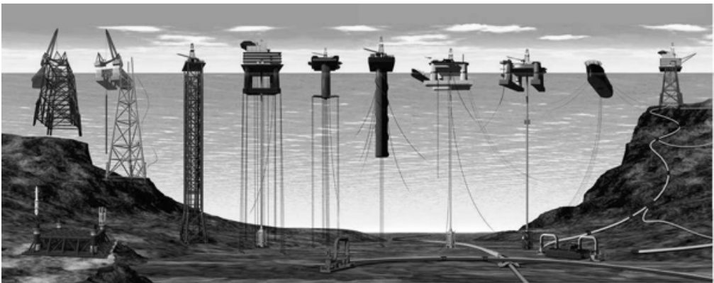
Slika 12. Tipovi pomorskih konstrukcija
