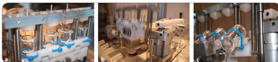
Slika 5. Automatizirana Korsakova metoda potenciranja primjenom stlačenog zraka: punjenje bočica i priprava razrjeđenja u omjeru 1:99 (a), deset snažnih potresanja u čvrstu podlogu (b), pražnjenje 99 % sadržaja bočice (c) nakon čega slijedi ponavljanje cijeloga postupka
