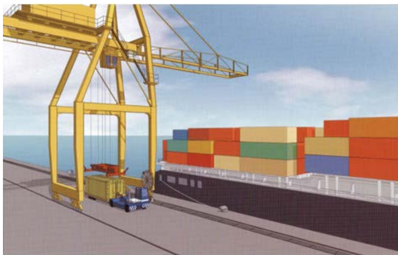
Slika 122. Obalna kontejnerska dizalica
