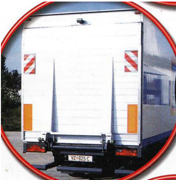
Slika 69. Prikaz teretnog motornog vozila nakon ugradnje hidraulične utovarne rampe
