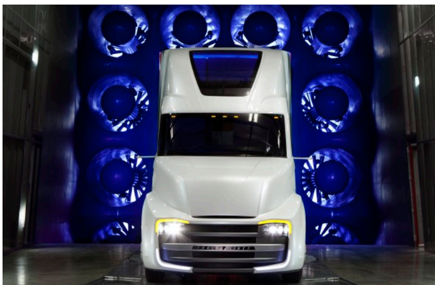
Slika 59. Kamere umjesto glomaznih retrovizora - recept za sjajnu aerodinamiku
