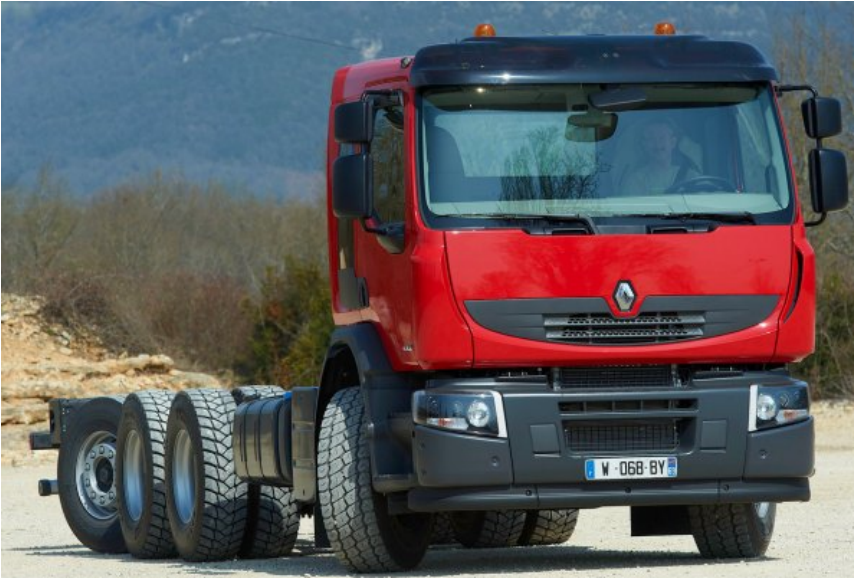
Slika 60. Renault Truck – s upravljivom stražnjom osovnom kao rješenje za veliku pokretljivost u uskim ulicama gradske mreže
