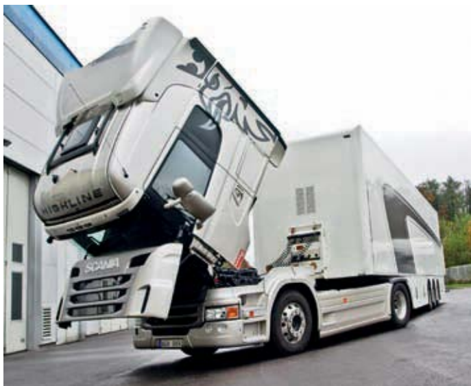
Slika 50. Laka dostupnost motornog prostora tegljača Scania R480
