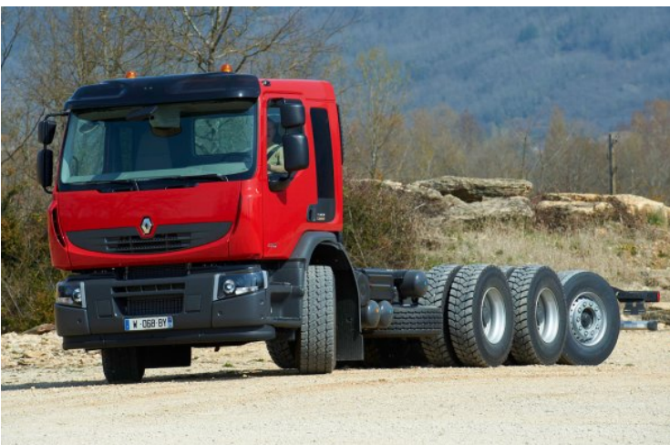
Slika 61. Stražnja upravljiva osovina ima mogućnost podizanja na otvorenoj cesti
