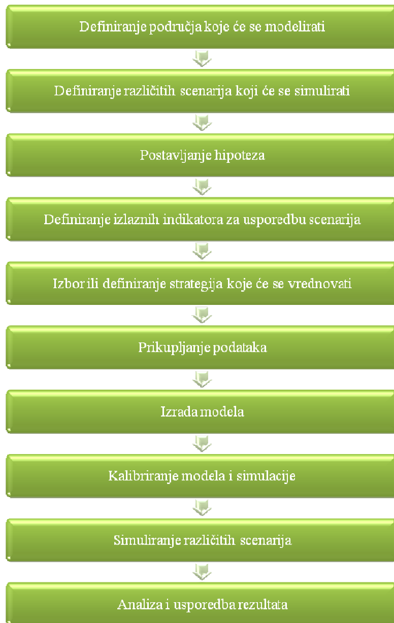
Slika 2. Postupak izradbe prometne simulacije
