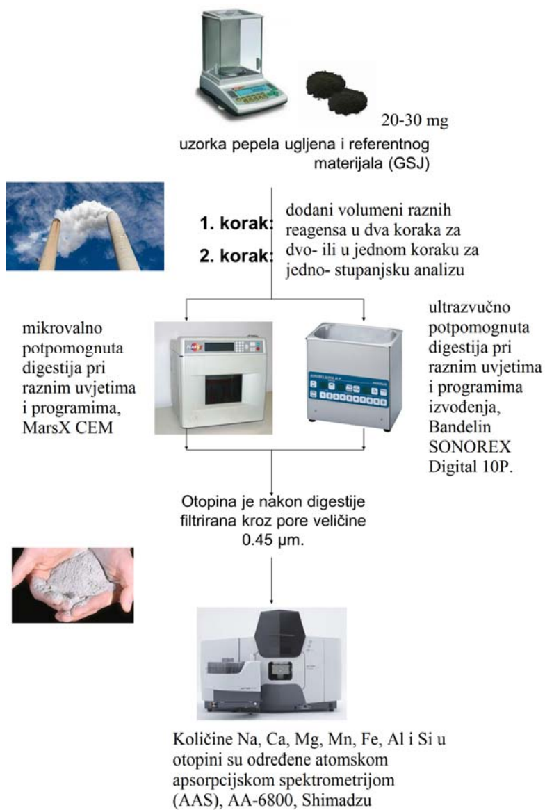
Slika 12. Shematski prikaz svih koraka pri izvođenju eksperimenata
