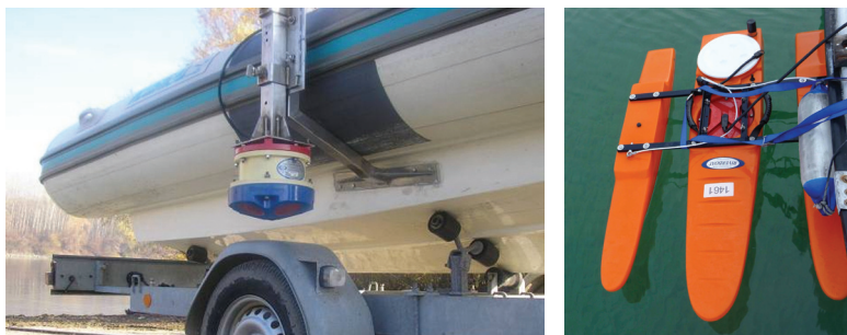
Slika 7. Položaj strujomjera na plovilu za mjerenje: (a) na rijekama i moru; (b) na manjim vodotocima
