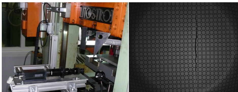
Slika 5.20 Stroj HUO 2-250-400 sa postavljenom monokromatskom kamerom objektiv Navitar (1024 x 768 ½ CCD), snimala se postavljena mreža kružnica [82]
