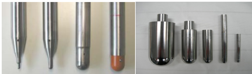
Slika 8.9 Prikaz različitih izvedbi alata koji se koriste u SPIF procesu oblikovanja [6, 12, 59, 61]
