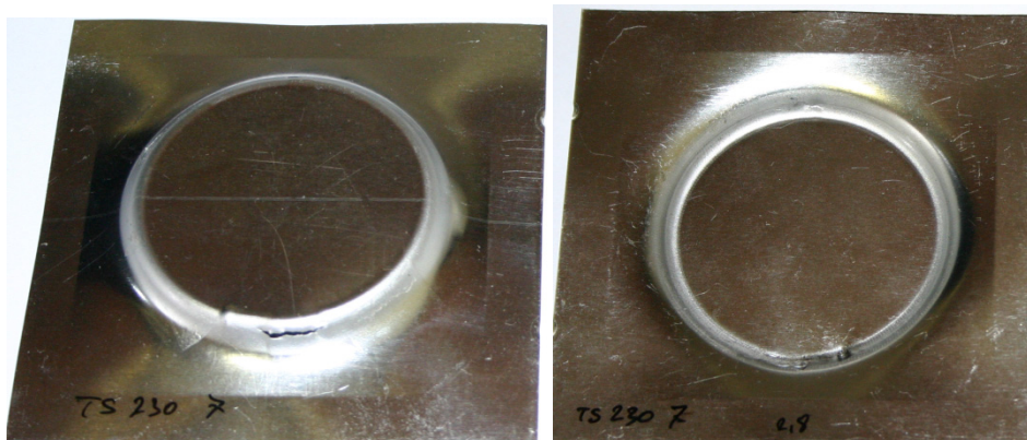
Slika 8.16 Uzorak TS230 - 7, kut 60° visina 7 mm
