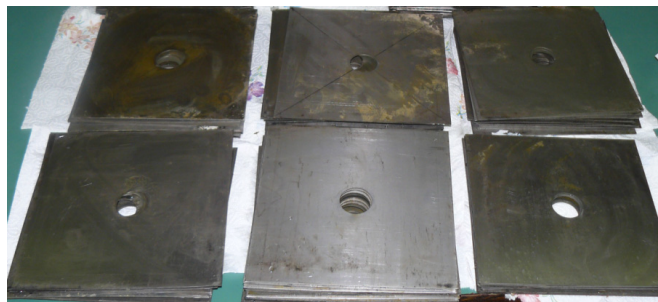
Slika 5.18 Pripremljene podložne ploče, materijal DC01 debljine 1 mm
