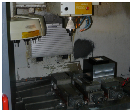
Slika 2.6 Radna naprava postavljena na glodalicu Bridgeport VMC 800, jedan od strojeva korišten u istraživanju
