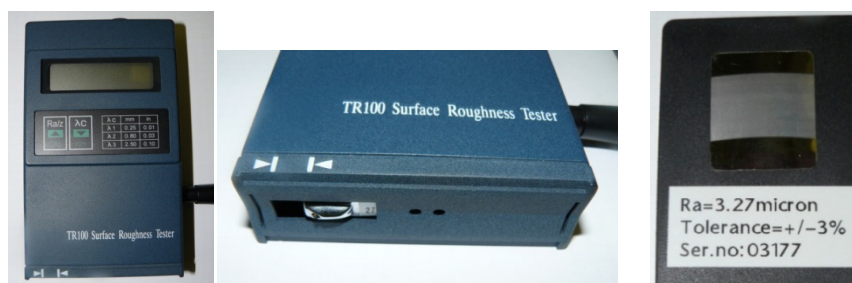
Slika 10.20 Korišten je uređaj za mjerenje hrapavosti TR-100 "Surface roughness tester" sa pripadajućim etalonom
