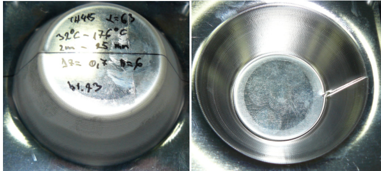
Slika 8.13 Prikaz izratka kut 63^\circ , lim TH415
