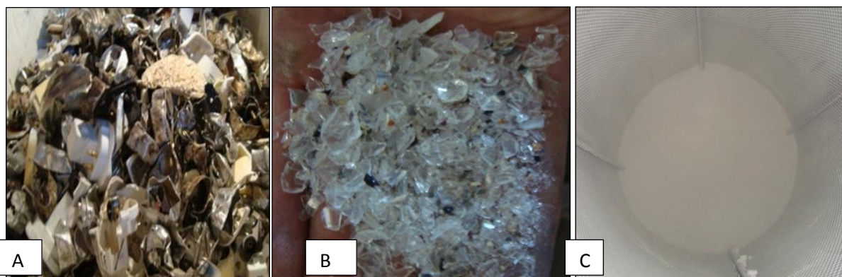
Slika 1. Sirovine dobivene recikliranjem fluorescentnih svjetiljki; A.) aluminij, B.) lomljeno staklo, C.) luminofor
