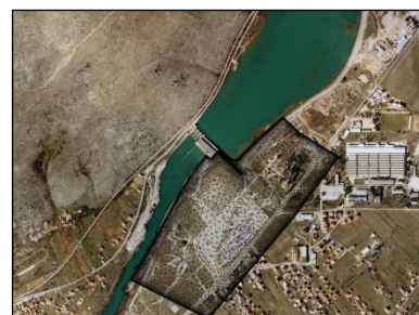
Slika 2. Mreža trokutnih konačnih elemenata na tlocrtnom modelu područja HEMO
