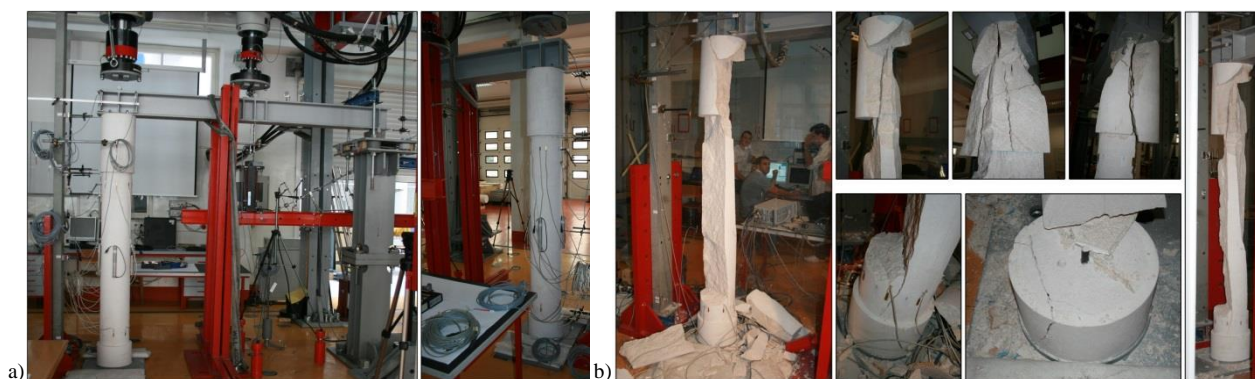
Slika 3. Laboratorijska ispitivanja: a) postavka ispitivanja i b) uzorak nakon sloma [2]
