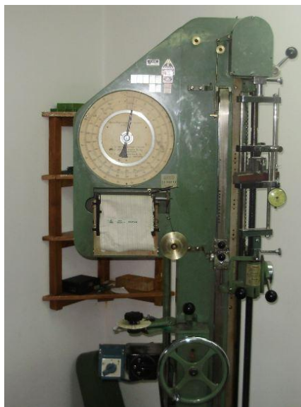
Slika 55. Ispitivanje savojne čvrstoće
