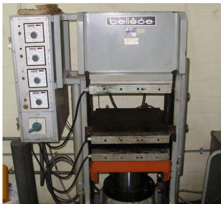
Slika 42. Preša PHPVEH 100 u kojoj su uzorci izrađeni
