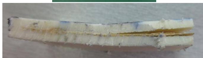
Slika 48. Epruvete nakon ispitivanja međuslojne smične čvrstoće
