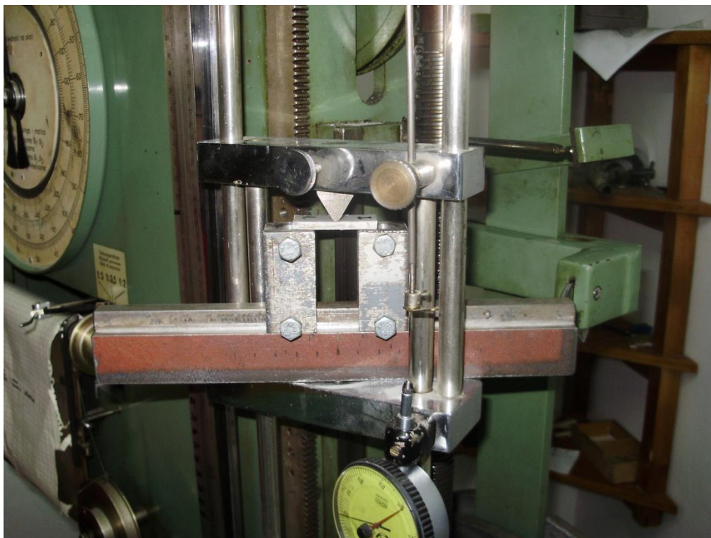
Slika 47. Ispitivanje međuslojne smične čvrstoće na kidalici
