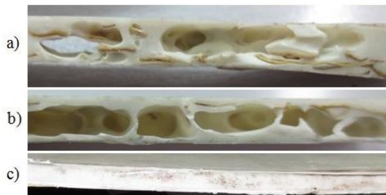
Slika 44. Čelijasta (a i b) i kompaktna struktura PLA (c)
