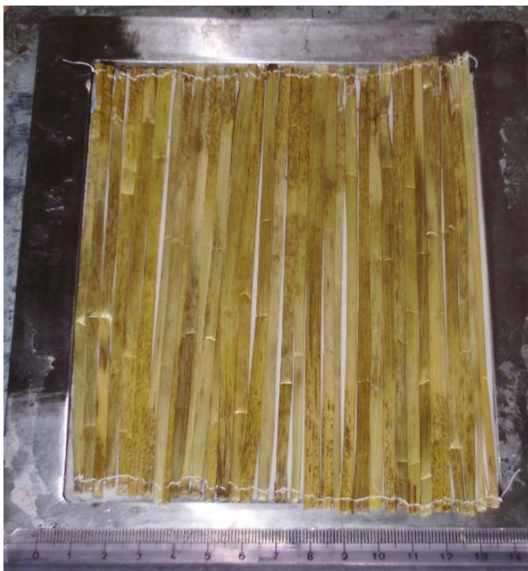
Slika 39. Priprema uzorka I. s unidirekcionalnim rasporedom slame
