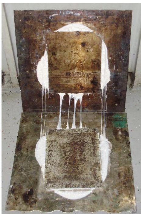
Slika 43. Vađenje folije iz kalupa
