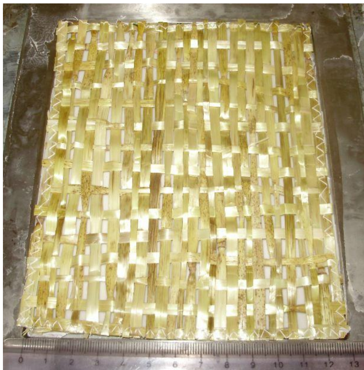
Slika 40. Priprema uzorka II. sa slamom u obliku tkanja
