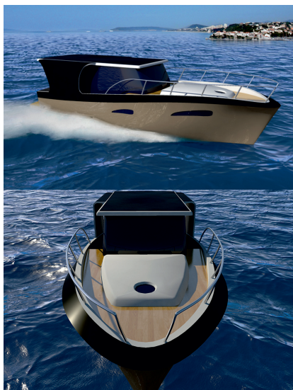
Slika 11. Smještaj solarnih panela na brodu - crne površine (krov nadgrađa - Bosch paneli, bokovi nadgrađa i trupa fleksibilni Uni-solar paneli)
