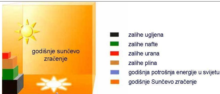
Slika 1. Godišnje Sunčevo zračenje na površini Zemlje u usporedbi sa zalihama fosilnih i nuklearnih goriva te godišnjom potrošnjom energije u svijetu [3]
