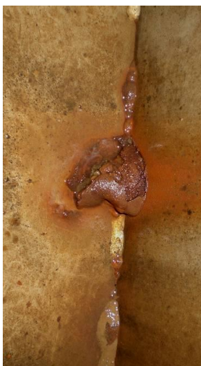
Slika 34: Tuberkuli u područjima procjeka diskontinuiranog zavarenog spoja (lijevo). Nehrđajući čelik AISI 304L, prirodna voda, nekoliko mjeseci. Mikrobiološkom analizom tuberkula utvrđeno je prisustvo aerobnih bakterija koje oksidiraju Fe i Mn (desno).
