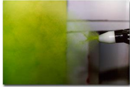
Slika 6: Elektrostatsko nabijanje praška – corona proces [14, 15].
