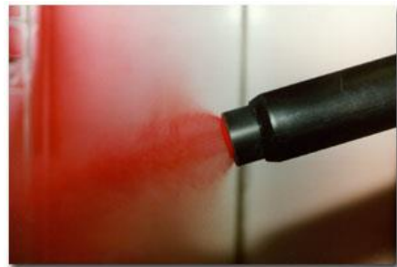
Slika 6: Elektrostatsko nabijanje praška – corona proces [14, 15].
