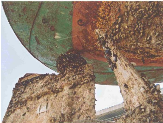
Slika 4: Obraštanje podvodnog dijela brodskog trupa Slika 5: Obraslo dno plutajuće platforme
