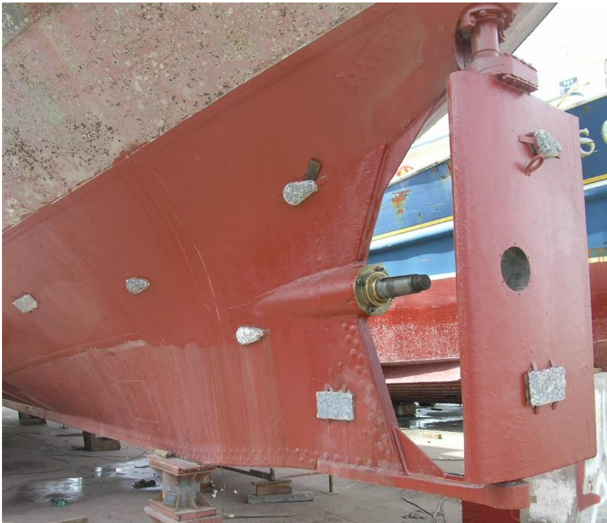
Slika 61: Protektorska zaštita podvodnog dijela čeličnog trupa broda žrtvujućim anodama od cinka.
