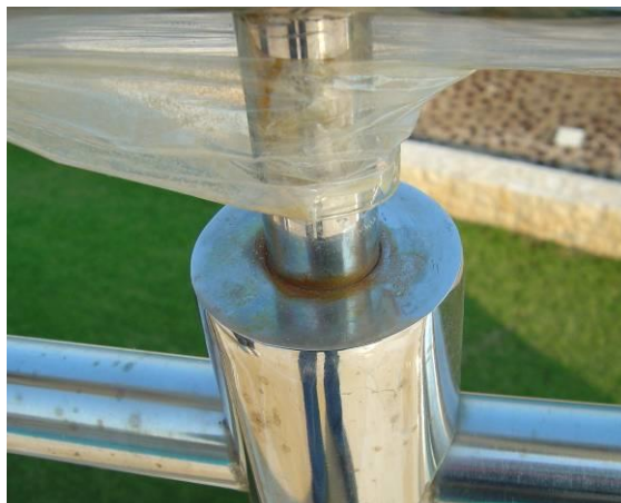
Slika 27: Koruzijsko oštećenje lima od nehrđajućeg čelika nastalo u područjima nalijeganja trake za pakiranje (lijevo) i koruzijska oštećenja ispod zaštitne folije na ogradi od nehrđajućeg čelika izloženoj morskoj atmosferi (desno).
