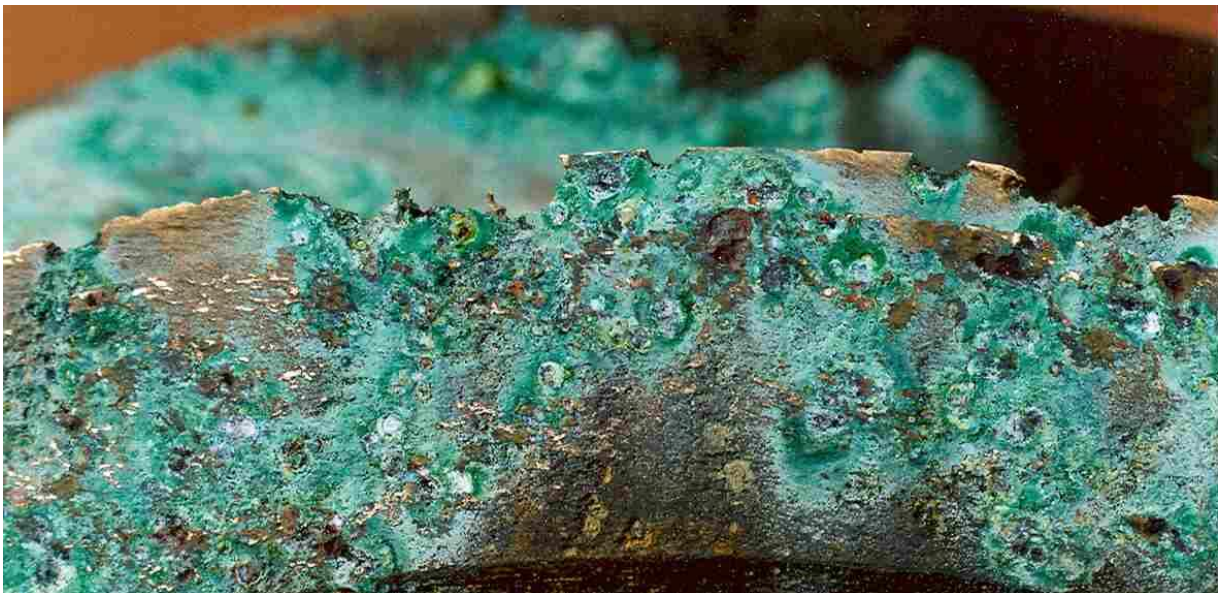
Slika 49: Erozijsko – korozijsko oštećivanje rotora mjedene pumpe tvrdim česticama
