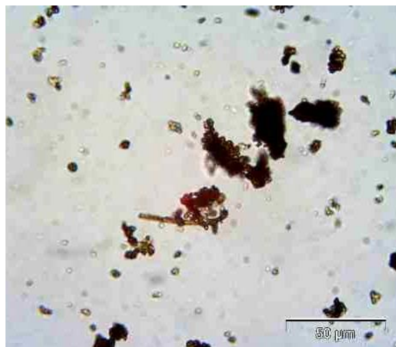
Slika 34: Tuberkuli u područjima procjeka diskontinuiranog zavarenog spoja (lijevo). Nehrđajući čelik AISI 304L, prirodna voda, nekoliko mjeseci. Mikrobiološkom analizom tuberkula utvrđeno je prisustvo aerobnih bakterija koje oksidiraju Fe i Mn (desno).
