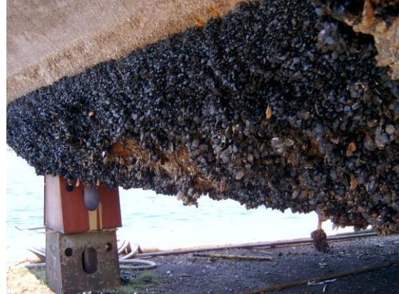
Slika 4: Obraštanje podvodnog dijela brodskog trupa Slika 5: Obraslo dno plutajuće platforme
