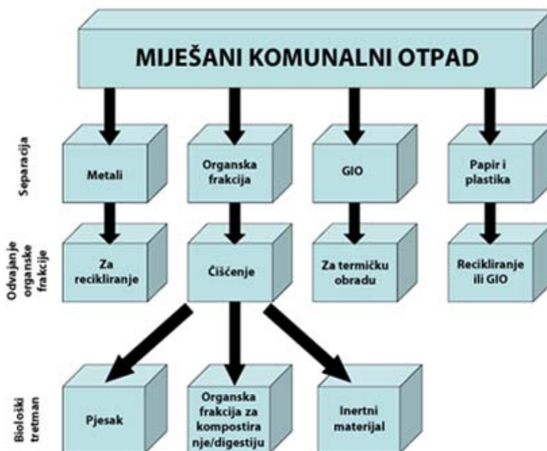
Slika 12. Shema procesa unutar postrojenja za MBO
