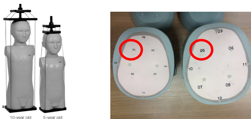
Slika 1. Antropomorfni dječji fantomi (lijeva slika) i pogled odozgo na sloj oba fantoma u kojem je smješteno središte tumora (desna slika). Brojevi označavaju rupe u koje se smještaju dozimetri. Kružnica je granica tumora
