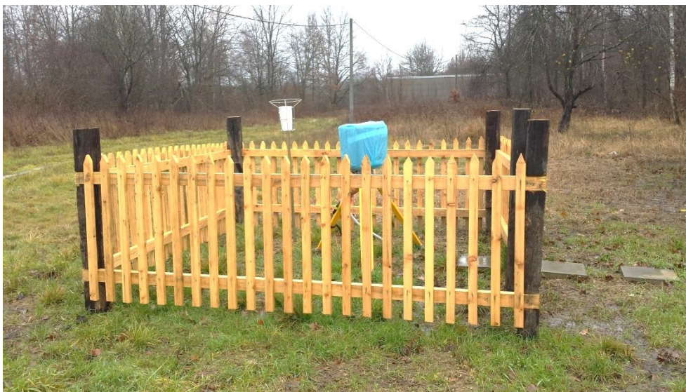
Slika 1. Mjerna stanica za mjerenje lokalnog pozadinskog zračenja RS 131 na lokaciji znanstveno-istraživačkog poligona „Šumbar“
