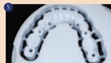
Sliki 2 in 3: Podatki za izdelavo iz digitalne postavitve so naloženi na programsko opremo (nesting software) in izrezkani iz belega resinskega bloka (Try-In).
