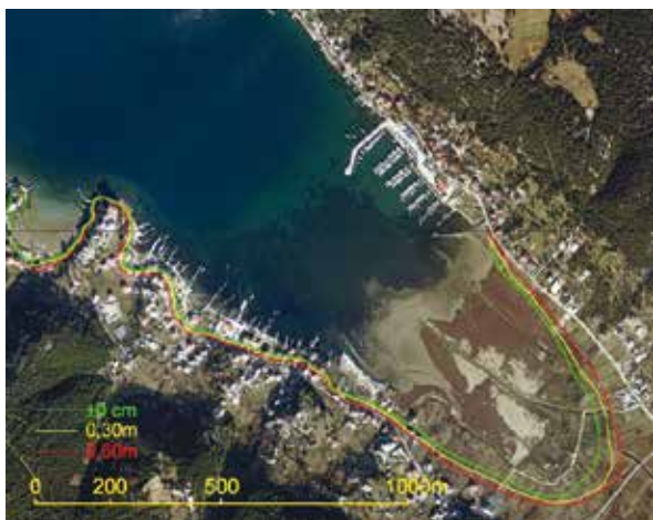
Slika 9. Supetarska Draga: učinak plavljenja u slučaju visoke morske razine 100 godišnjeg povratnog perioda (1,30 m n.m.) i predviđenih stagnacije i povećanja razina mora od 30 i 60 cm.
