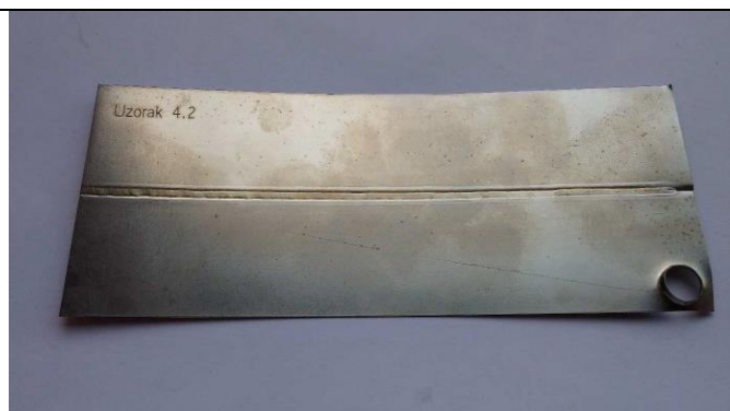
Slika 13. Ispitni uzorak 4.2 nakon slane komore
