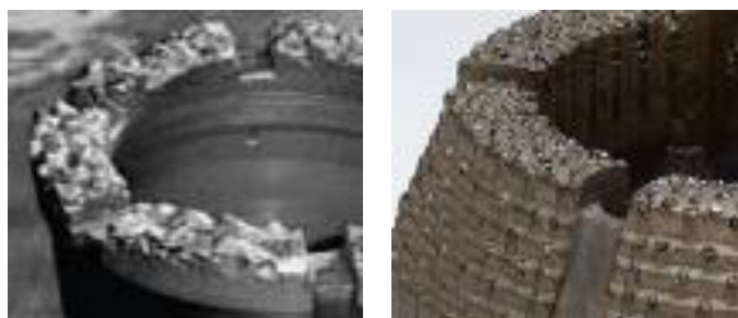
Slika 8. Kruna izrađena od TM (lijevo) i od abrazivnih zrna (desno)
