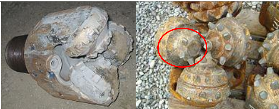
Slika 20. Djelomično i potpuno istrošen trostrani umetak
