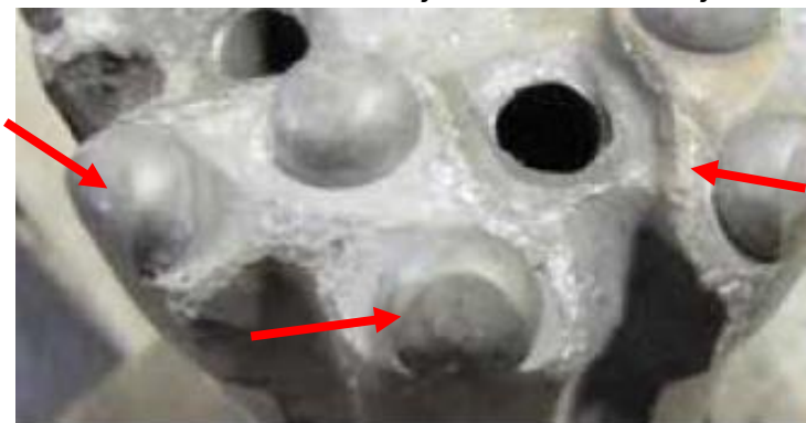
Slika 18. Obodno trošenje krune
