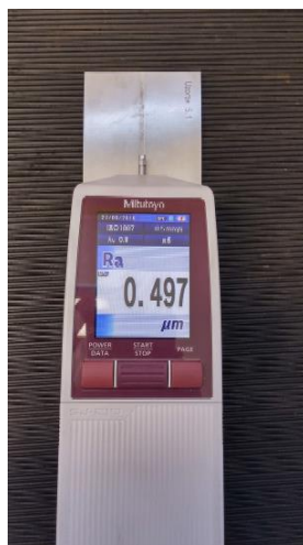
Slika 5. Mjerenje hrapavostu uređajem Mitutoyo „SJ-210“
