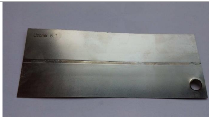
Slika 15. Ispitni uzorak 5.1 nakon slane komore
