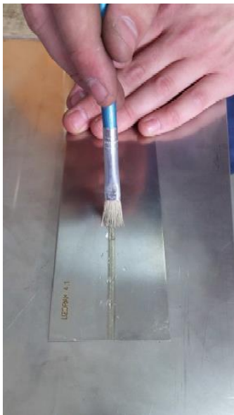
Slika 3. Kemijsko čišćenje ispitnog uzorka
