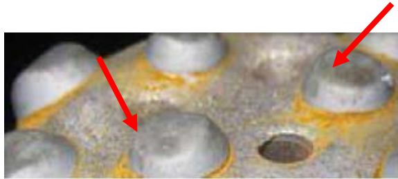
Slika 17. Čeono trošenje krune za bušenje tla
