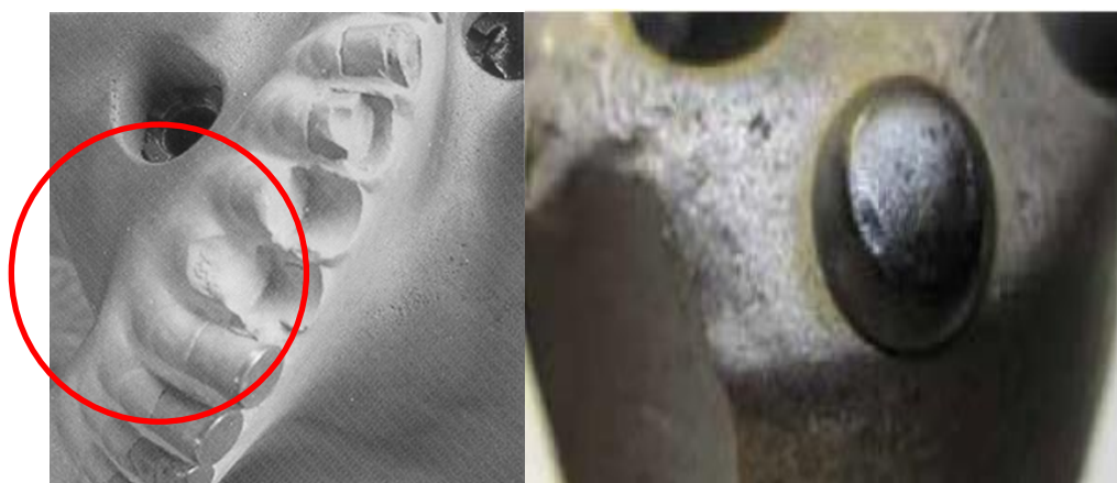
Slika 23. Potpuni lom rezne oštrice
