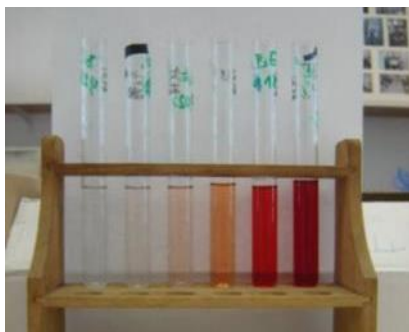
a. kupelj nakon bojadisanja merceriziranog pamuka
