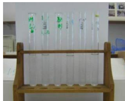
b. kupelj nakon bojadisanja/pročišćavanja kationiziranim pamukom
