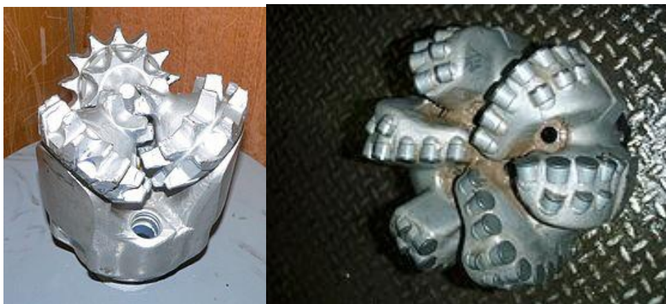
Slika 12. Vrh svrdla za bušenje tla (trostrani) (lijevo), Vrh svrdla za vertikalno (čeono) bušenje (desno)
