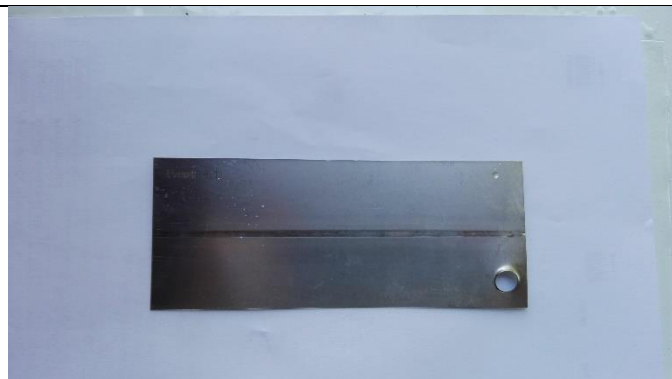
Slika 14. Ispitni uzorak 5.1 nakon vlažne komore
