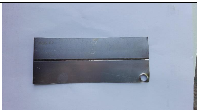
Slika 12. Ispitni uzorak 4.2 nakon vlažne komore
