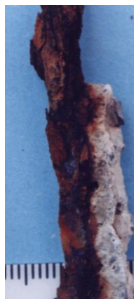
Slika 41: Korozija čelične armature u betonu: a – shematski prikaz mehanizma, b – pukotine u betonu uslijed korozije armature (armiranobetonski rasvjetni stup), c – oštećena čelična armatura mosta, d – odlomljavanje betona uslijed korozije armature na uronjenom nosivom stupu.
