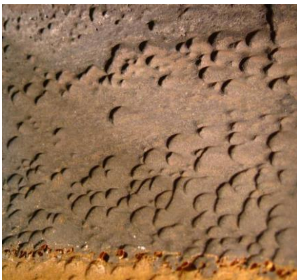
Slika 31: Impingement corrosion - erozijsko korozijsko oštećivanje površine kapljicama - oštećenja u obliku rupica - kopita na stjenci cijevnog koljena u petrokemijskom postrojenju (lijevo) i SEM snimak detalja rupice uslijed erozijsko korozijskog razaranja, ~63× (desno).
