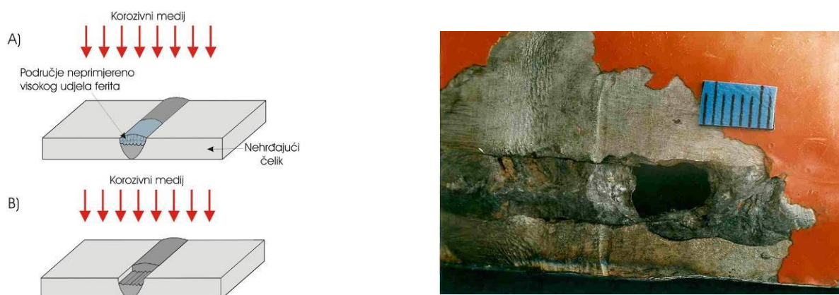
Slika 27: Primjer selektivne korozije područja zavarenog spoja s neprimjereno visokim udjelom delta ferita – lijevo shematski prikaz, desno – lokalno oštećenje zavarenog spoja u području pripoja.
