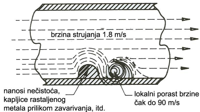
Shema lokalnog povećanja brzine strujanja medija kod nailaska na prepreku strujanju.
