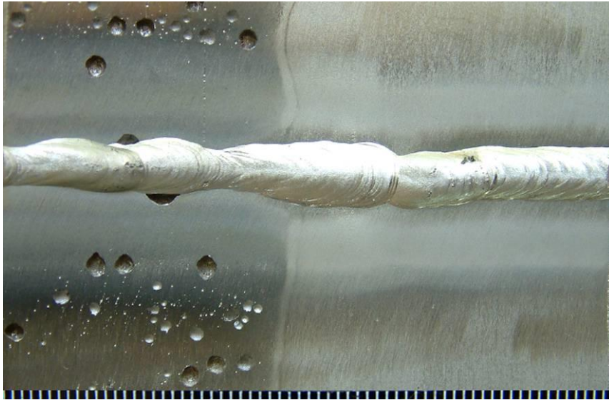
Slika 23: Prikaz rezultata laboratorijskog korozijskog ispitivanja otpornosti na rupičastu koroziju, AISI 304L.
