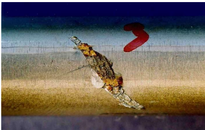
Slika 19: Korozija u procjepu u području dosjeda na izmjenjivaču topline kojim je protjecala morska voda, nehrđajući čelik AISI 316L, nekoliko mjeseci.
