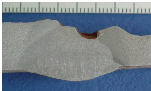
Erozijsko korozijsko oštećivanje na zavarenom spoju cijevi i T-komada (prepreka strujanju).
