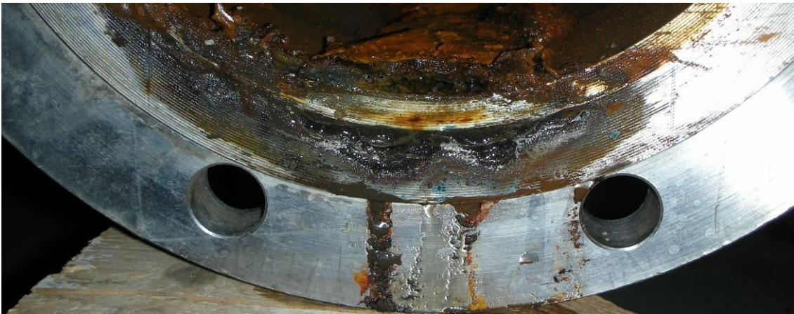
Slika 20: Korozija u procjepu poticana mikroorganizmima – prirubnički spoj od čelika AISI 316Ti, prirodna voda, nekoliko mjeseci.
