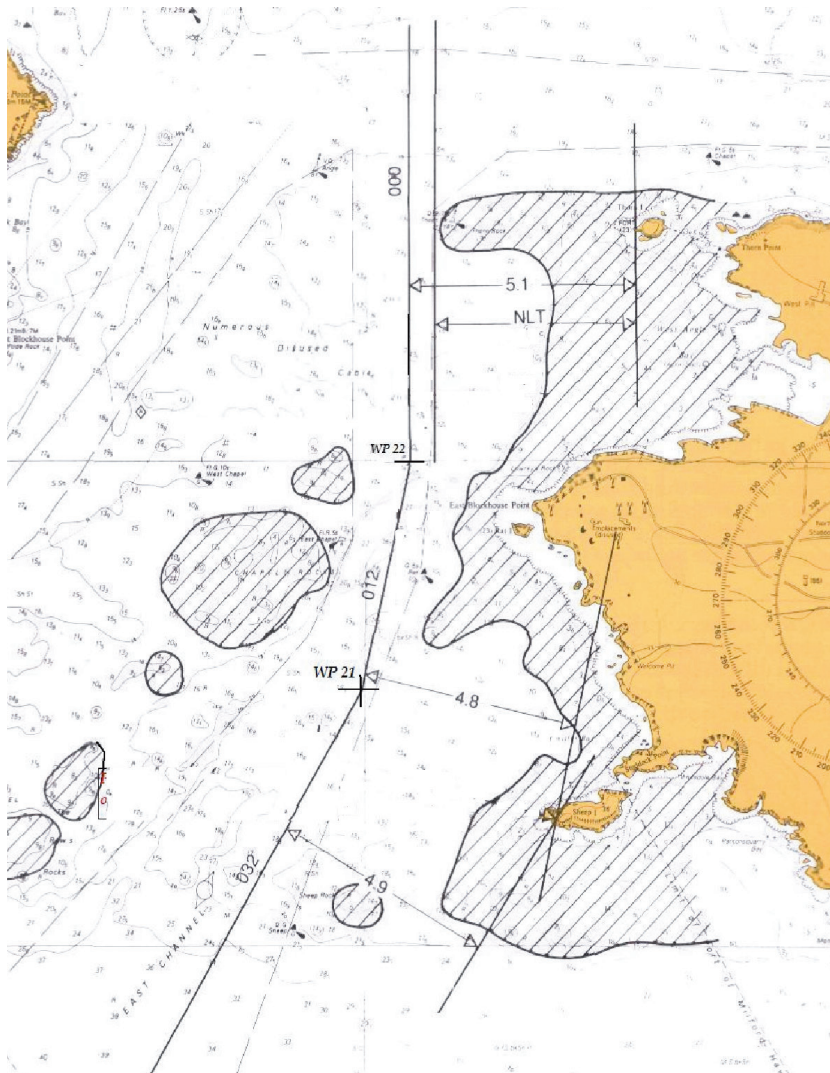
Slika 39. Ucrtavanje paralelnih indeksa i kurseva broda u odnosu na markantne objekte na kopnu/otoku (prema Bridge Team Management)
