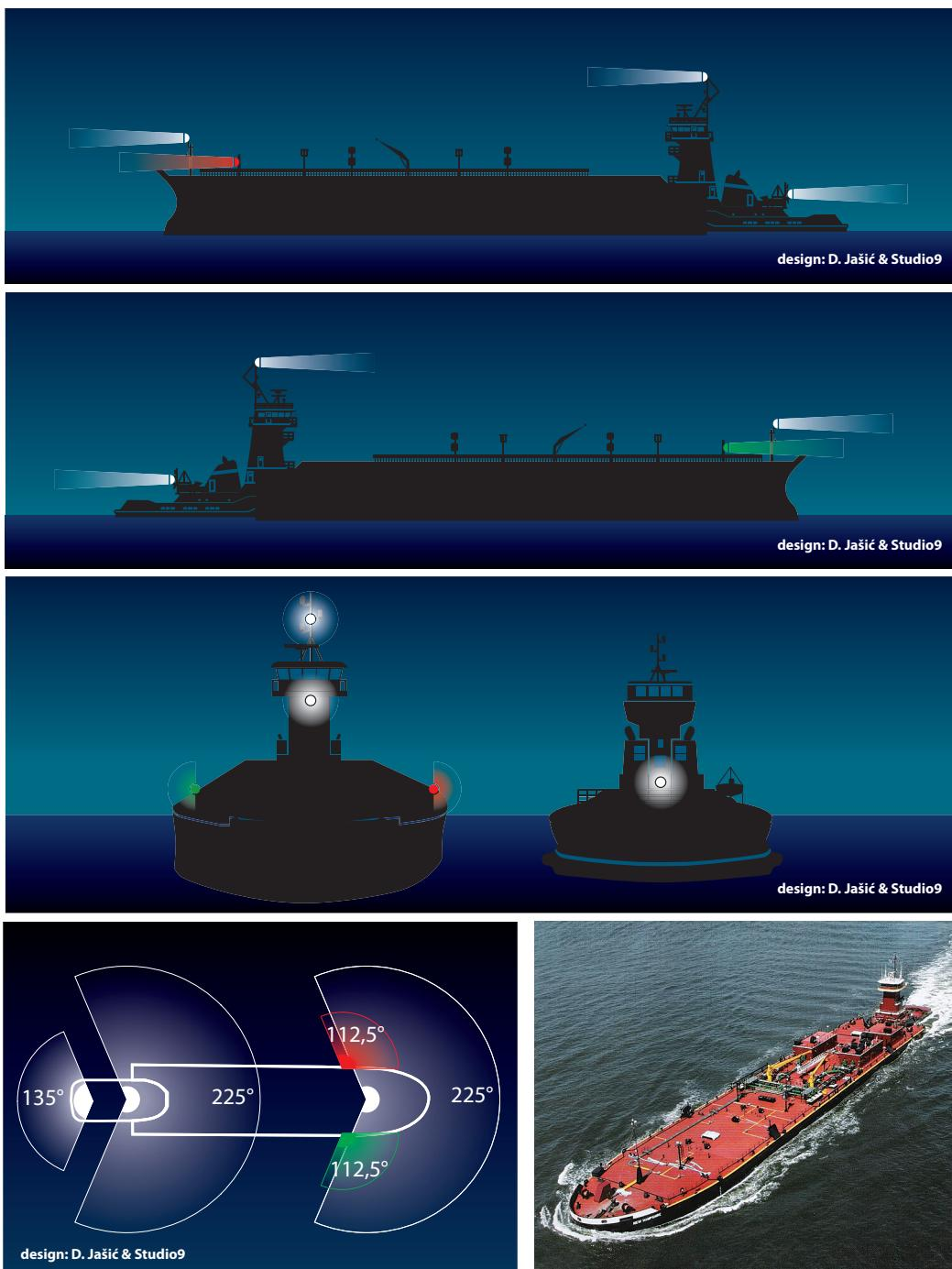
c) Kada brod na mehanički pogon potiskuje naprijed ili tegli bočno, osim u slučaju kada čine jednu složenu jedinicu, mora isticati:
