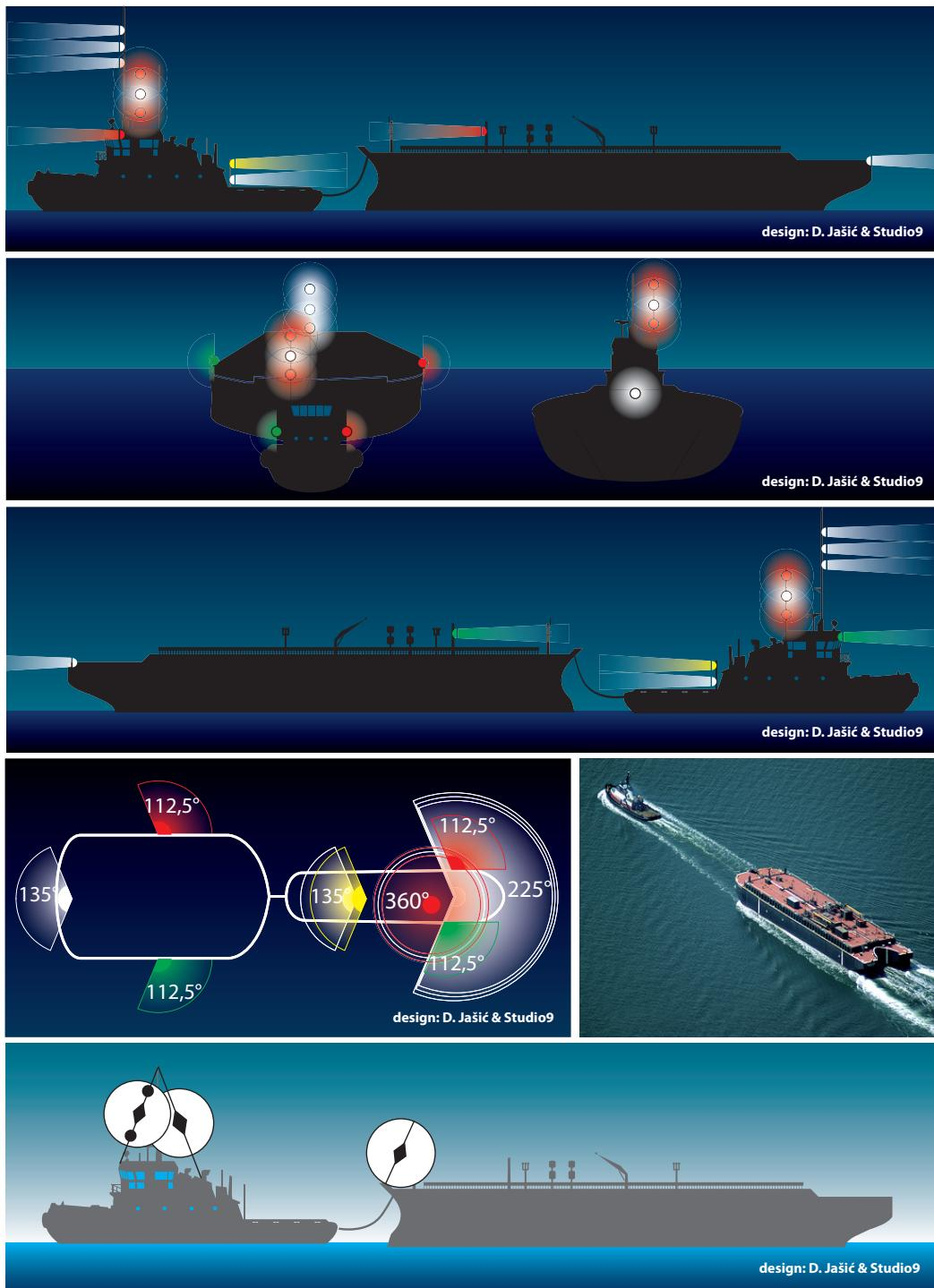
b) Ako su potiskivač i brod koji on potiskuje čvrsto spojeni da čine jednu složenu jedinicu, smatraju se brodom na mehanički pogon i moraju isticati svjetla propisana u Pravilu 23. ovoga pravilnika.
