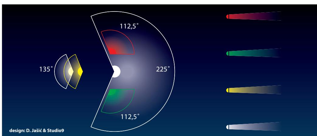
d) **Svetlo za tegljenje** označava žuto svjetlo istih osobina kao "krmeno svjetlo" određeno stavkom (c) ovoga pravila.
