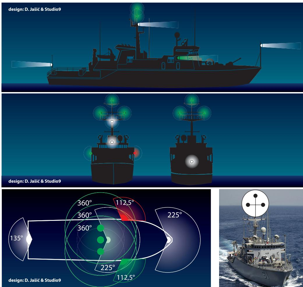
vilnika, ili osim svjetala ili znakova propisanih za usidrene brodove u Pravilu 30. ovoga pravilnika, isticati i tri zelena kružna svjetala ili tri kugle. Jedno od tih svjetala ili znakova mora biti postavljeno blizu vrha pramčanog jarbola, a druga dva po jedno na krajevima donjeg križa pramčanog jarbola.
