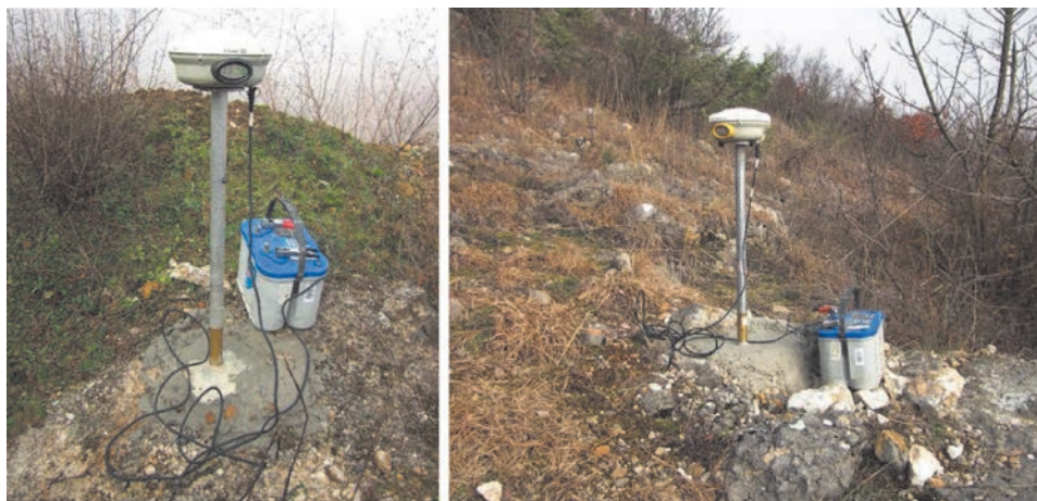
Slika 3. Prisilno centriranje na točkama Karakašica i Lučani.
