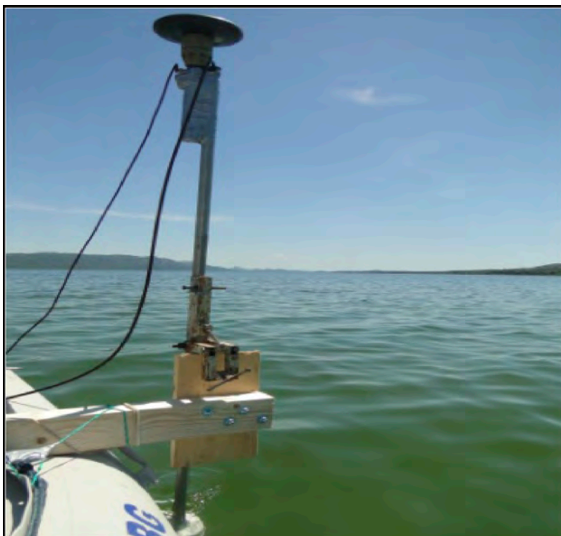
Slika 2. Korišteni gumenjak s montiranim drvenim nosačem.
