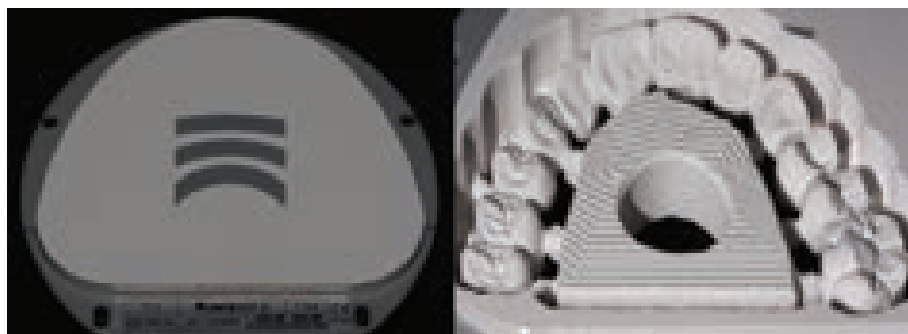
Slika 16-13. Blok presinteriranoga cirkonijeva dioksida prije i nakon glodanja Ceramill ZI (Amman Girbach).
