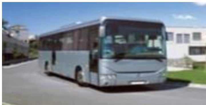
Slika 34. Autobus prigradsko-međugradskoga tipa marke Iveco Irisbus model Crossway za kratke ili srednje udaljenosti
