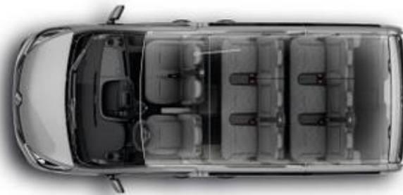
Slika 39. Primjer tlocrtnog rasporeda sjedala vozila u kombinaciji 8+1
