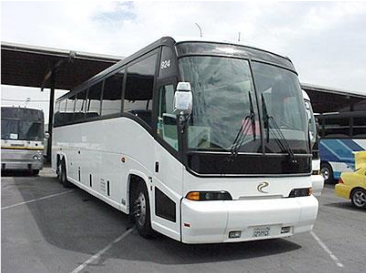
Slika 12. Primjer standardne izvedbe troosovinskoga autobusa za međugradski linijski promet
