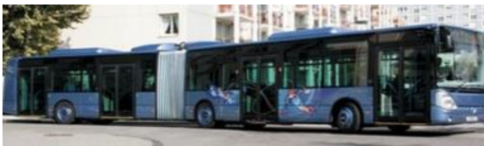
Slika 7. Zglobni gradski niskopodni troosovinski autobus s četvorima vratima
