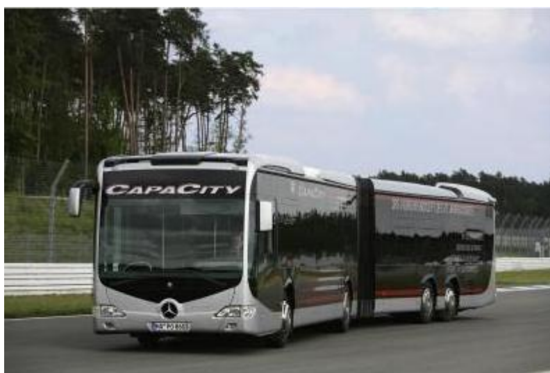
Slika 14. Zglobni gradski autobus s četiri osovine marke Mercedes-Benz
