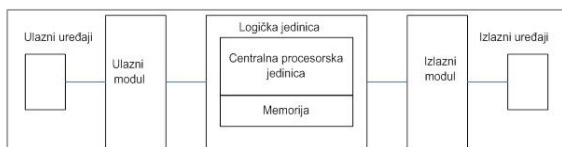
Slika 1. Osnovni elementi programabilnog logičkog kontrolera (PLC); Izvor: [6,5]
