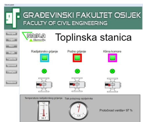
Slika 7. Podsustav CNUS-a za grijanje fakultetske zgrade
