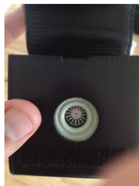
Slika 9. Kalibrator za umjeravanje zvukomjera.
