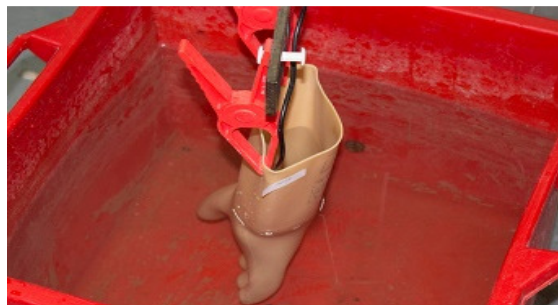
Slika 8. Ispitivanje izolacijske rukavice
