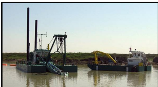
Slika 4. Plovni bager za održavanje plovnih putova [7]
