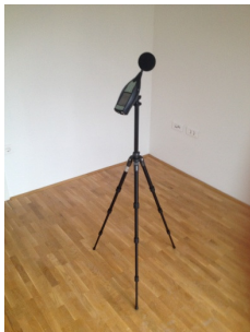
Slika 10. Zvukomjer postavljen na pripadajući stalak s podesivom visinom.
