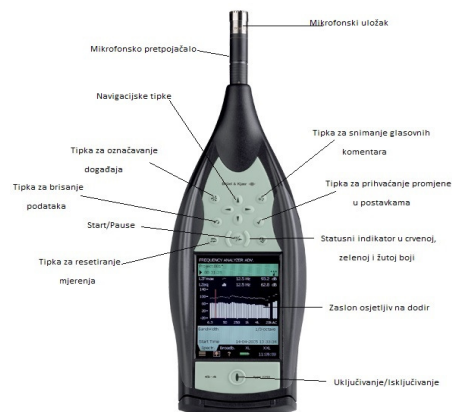
Slika 8. Zvukomjer tip 2250 Brüel & Kjaer.
