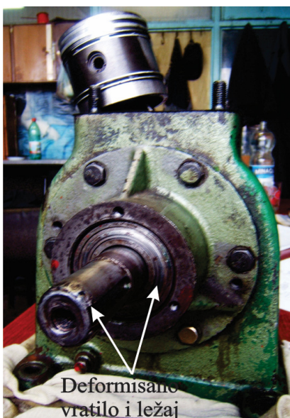
Slika 3. Dijagnostikovanje stanja klipnog kompresora [7]
