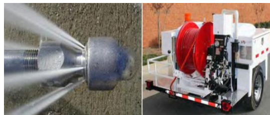
Slika 4. Mlaznica (lijevo) i prikolica za ispiranje (desno) [8]
