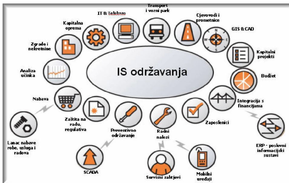
Slika 1. Struktura suvremenog informacijskog sustava za podršku upravljanju održavanjem [3]
