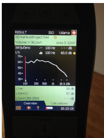
Slika 12. Grafički prikaz rezultata mjerenja udarne zvučne izolacije.
