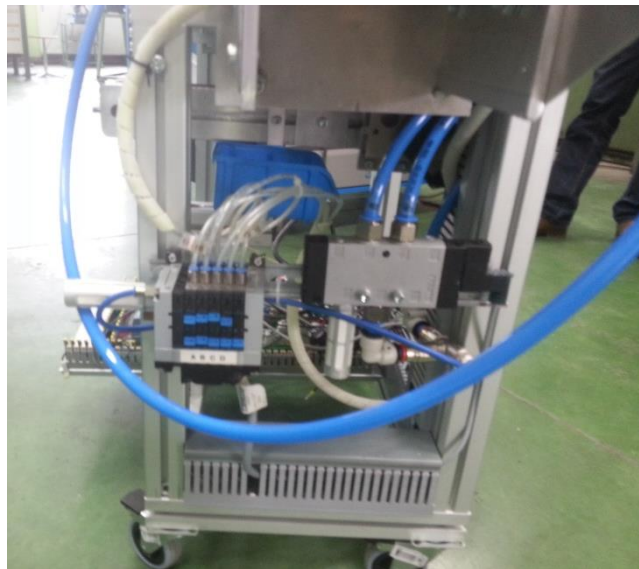
Slika 5: Pnevmski deli naprave (osebni vir – dijaki, 2014)
