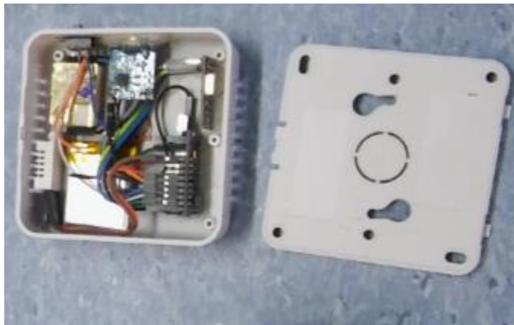
Slika 4: Izdelan merilnik mikroklime
