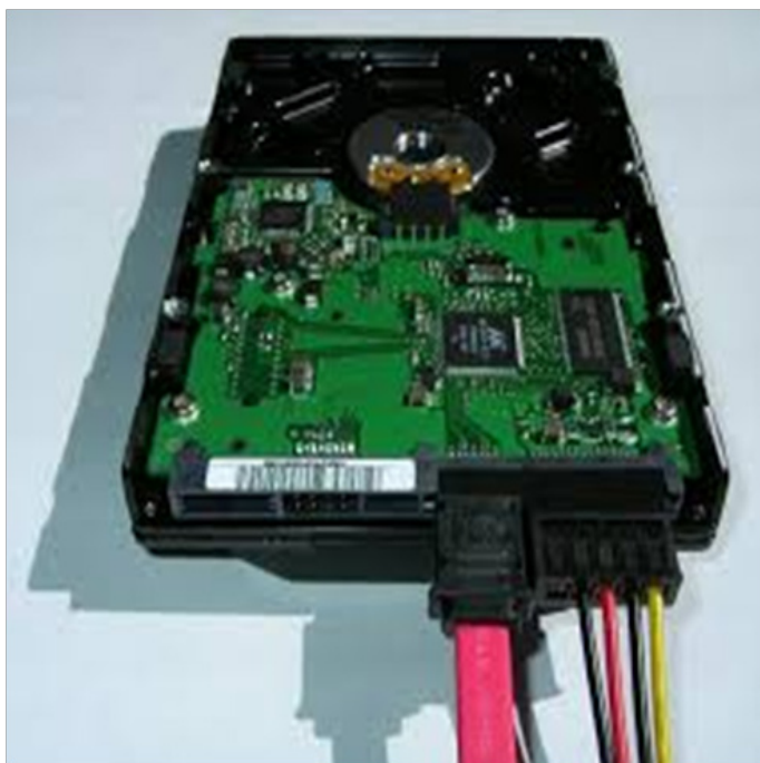
Slika 2: HDD priključen S-ATA kablom Izvor: https://de.wikipedia.org/wiki/Serial_ATA
